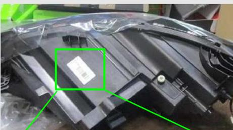
Se è necessario sostituire il proiettore, è necessario verificare la data di produzione.
